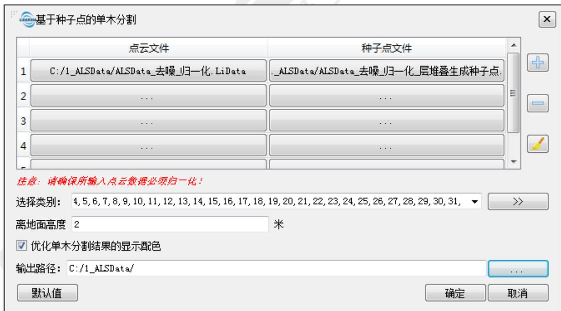
3.2 分割完成后，将点云数据加载到软件中，点击菜单栏的
