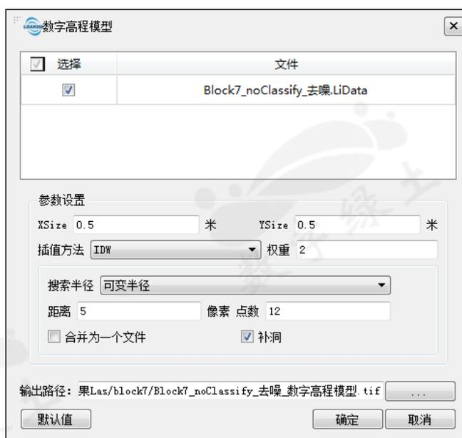
选择需要生成 DEM 的文件（应勾选至少一个文件），然后将 XSize 和 YSize 均设置为 0.5。插值方法选择 IDW，将得到左下图所示的 DEM，选择 TIN 方法后将得到右下图所示的 DEM。
