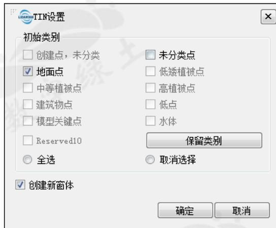
单击确定，则右侧出现新窗口，此窗口与点云所在窗口处于联动状态（可以先退出**选择区域地面点分类**，以免影响显示效果）。此时方法面板中的**TIN 滤波**、**二次曲面滤波**等方法变成可用状态。
