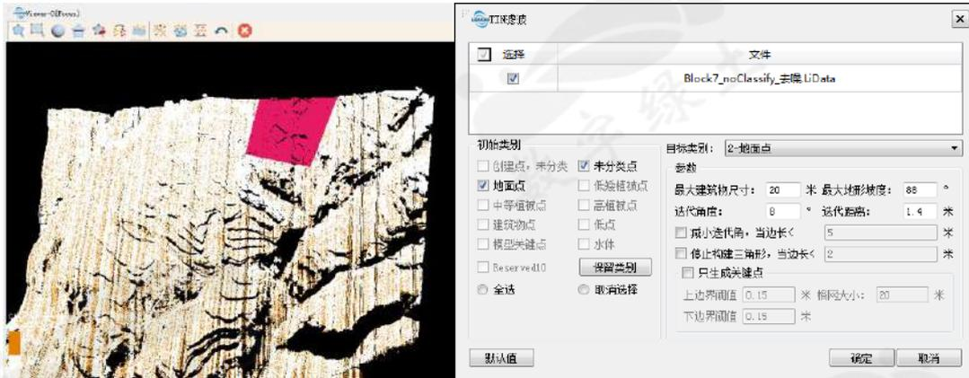
单击**TIN 滤波**按钮
