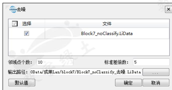
去噪完成后将新生成的 LiData 文件添加到软件中，然后在左侧图层管理窗口将原始点云隐藏以观察去噪后的效果。倘若此时还有未去除的孤立点，可以减小标准差倍数后继续进行去噪，或手动将该类别分类为噪声点并在后续处理中令该类别不参与运算。
