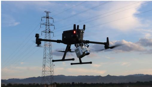
LiAir X2 是北京数字绿土科技有限公司自主研发的一款轻小型智能化无人机激光雷达系统。系统集成了激光雷达传感器、惯性导航系统，机载运算存储控制单元、数码相机，可智能化自主跟线飞行，无需提前规划航线，专门针对电力线主、配网的智能巡检作业开发。
