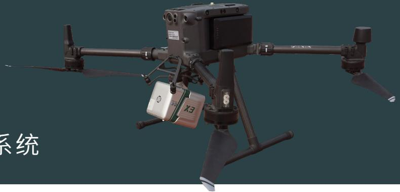
LiAir X3 是数字绿土研发的第三代架空线路智能自主巡检系统，采用全新的一体化设计风格，集成轻小型激光雷达、自研惯导、高分辨率测绘相机以及高算力边缘计算平台，相比上一代产品，复杂环境下仿线成功率更高，功能更加强大，可实现特定环境下的全自主巡线作业，无需航线规划，简化作业流程，大幅提高作业效率。
