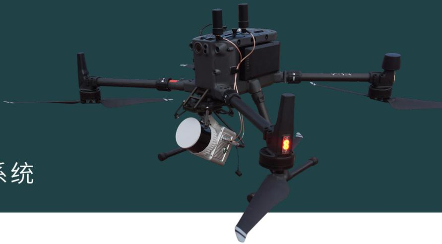
LiAir X3C 是数字绿土自主研发的第三代架空线路智能自主巡检系统，搭载 AirPilot 智能自主飞行算法，延续 X 系列产品 L3 级别的“自动驾驶”能力，集成 360 度环扫激光雷达，带来作业效率和数据质量的进一步提升，是一款将智能化、高效率、高质量、高性价比集于一身的激光雷达系统。
