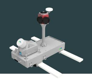
LiMobile M1 移动激光扫描系统搭配倾斜 45 度安置的激光雷达、高分辨率相机和 Ladybug5+ 全景相机,可快速获取道路及周围地物的三维数据;同时预留丰富的扩展接口,支持选配车轮编码器;支持 2 TB 可插拔硬盘,便于大数据量的存储和拷贝;一体化的车载支架设计,可安装在不同车型上使用;搭配数字绿土自研的 LiDAR360 MLS 软件可实现一站式数据处理到行业成果交付。
